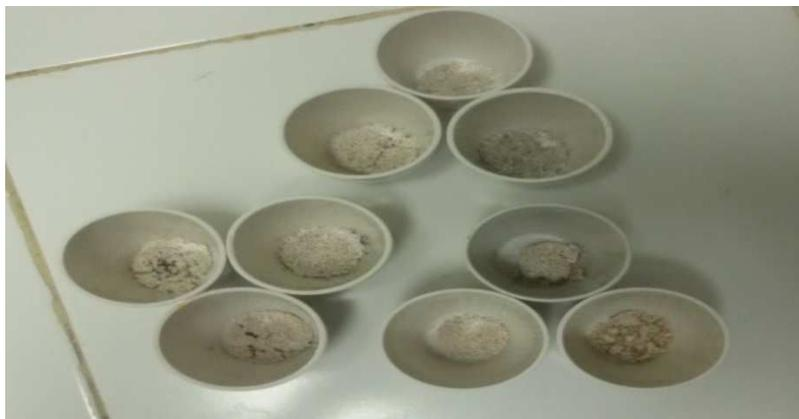
**Figura 18** - Determinação de cinzas nas amostras de coco
