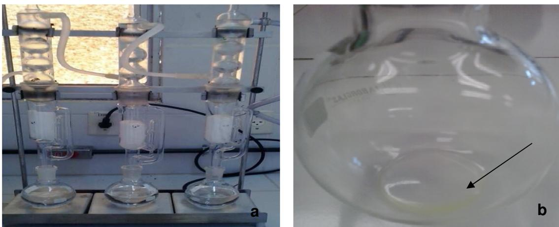
**Figura 17** - Processo de extração dos lipídeos (a); Fração lipídica obtida (b).
