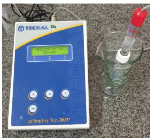
Figura 20 - Medidor de pH
